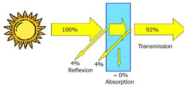
Abbildung 9: Schematische Zeichnung der Lichttransmission von eisenarmen Gläsern
